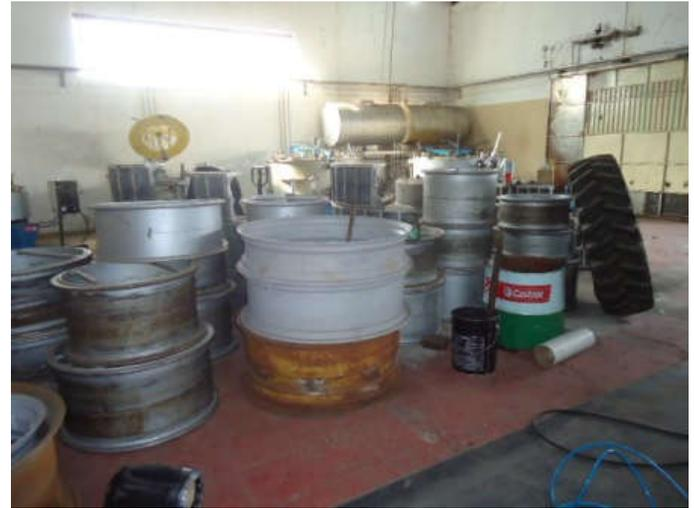
Foto 28: Moldes para formato dos pneus de tratores
