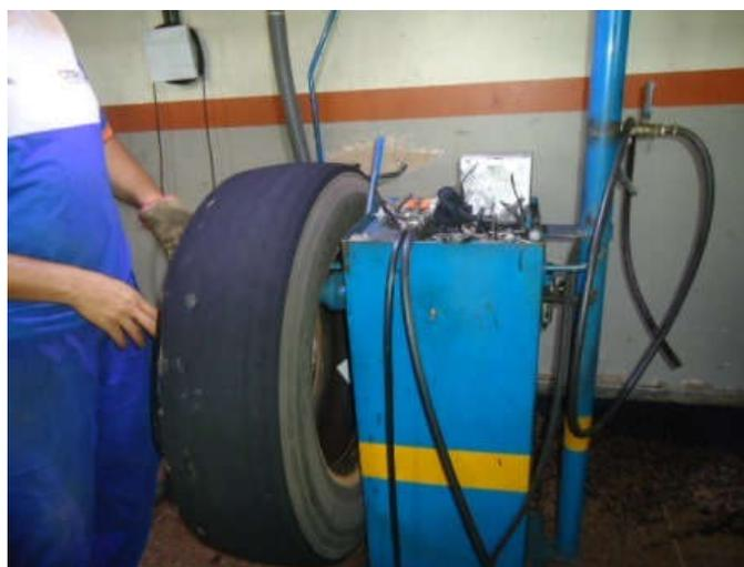
Foto 09: Processo de escareação dos pneus.
