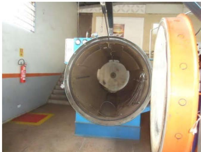
Foto 24: Parte interna da autoclave
