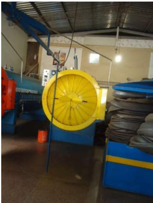
Foto 23: Autoclave para o processo de vulcanização
