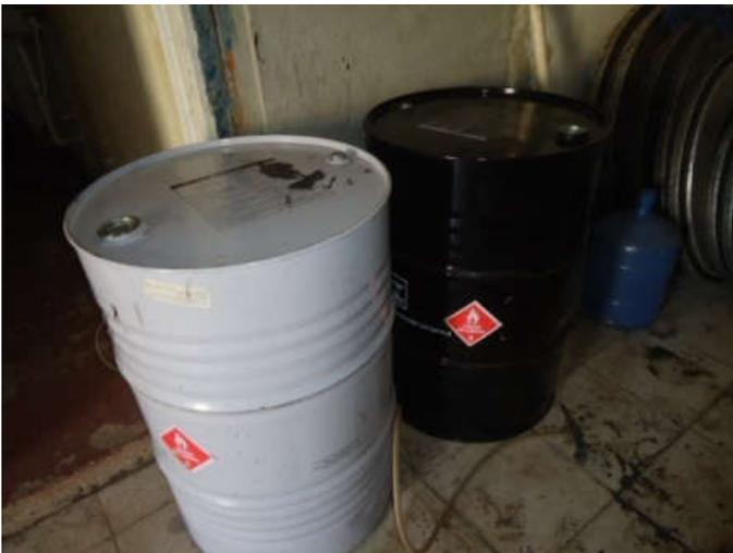
Foto 33: Estoque de produtos perigosos inadequadamente, sem a contenção
