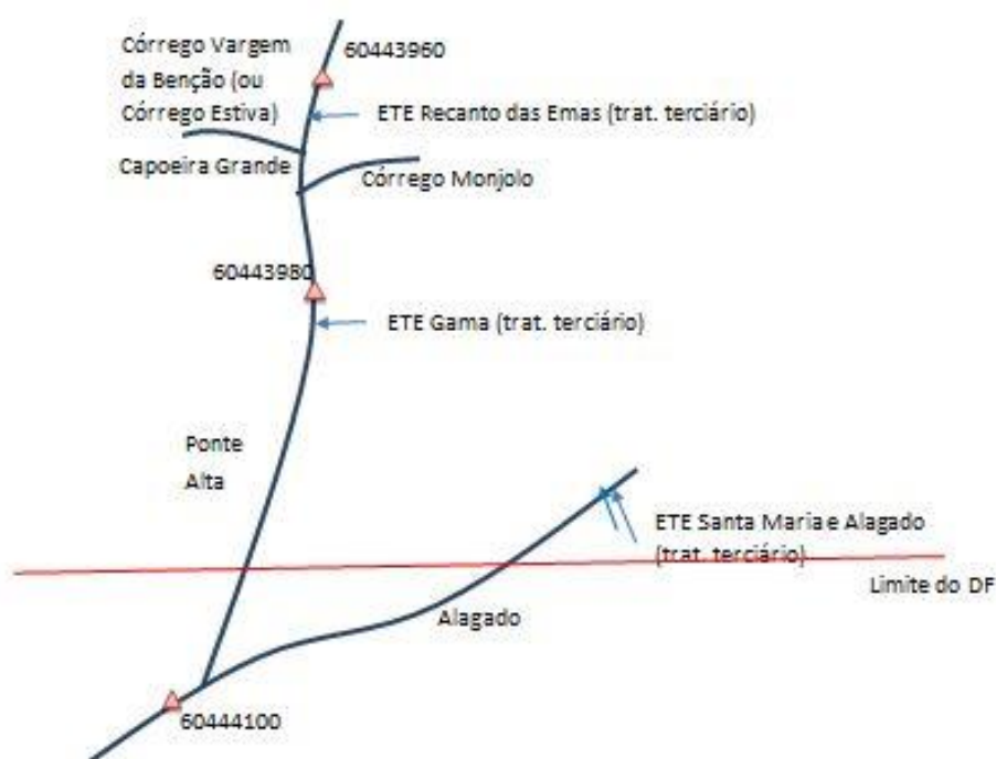
Figura 02. Diagrama esquemático dos cursos d'água Córrego Estiva (ou Vargem da Benção), Rio Ponte Alta e Rio Alagado, com localização das estações fluviométricas e pontos de lançamento das ETEs do DF.
